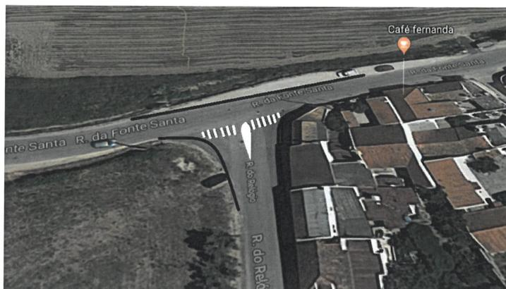
Figura 3. Exemplo da implementação de uma ilha com a marcação de passadeira para peões.
